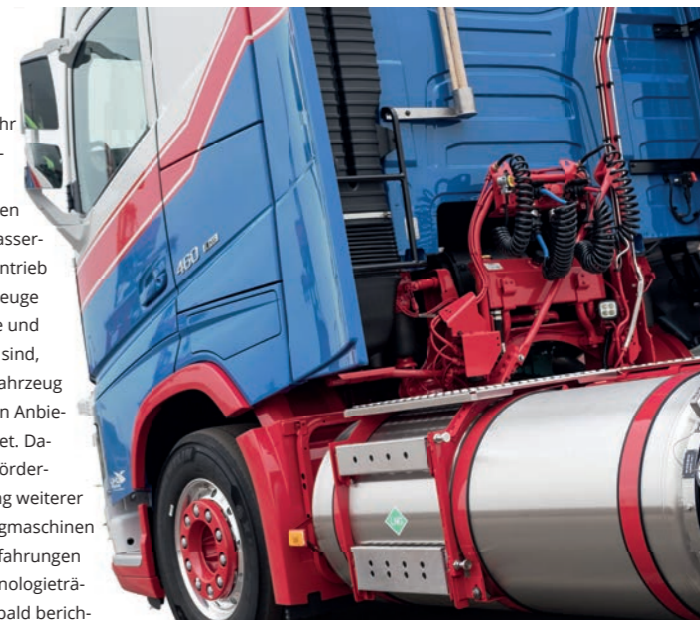
Innovative Technik: Die Spedition Kruse lässt einen Lkw auf Wasserstoff-Brennstoffzellenantrieb umrüsten. © Spedition Friedrich A. Kruse
