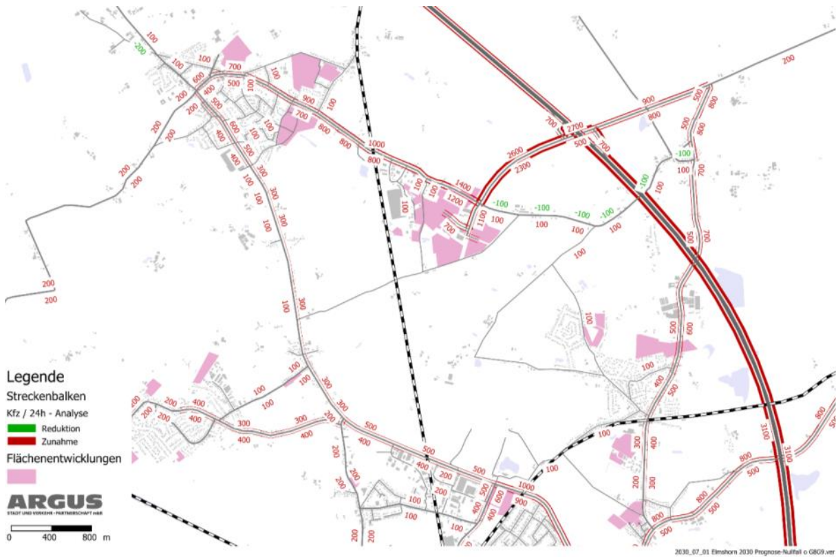
Abbildung 11: Belastungsdifferenz zwischen Prognose-Nullfall und Analysefall (DTW)
