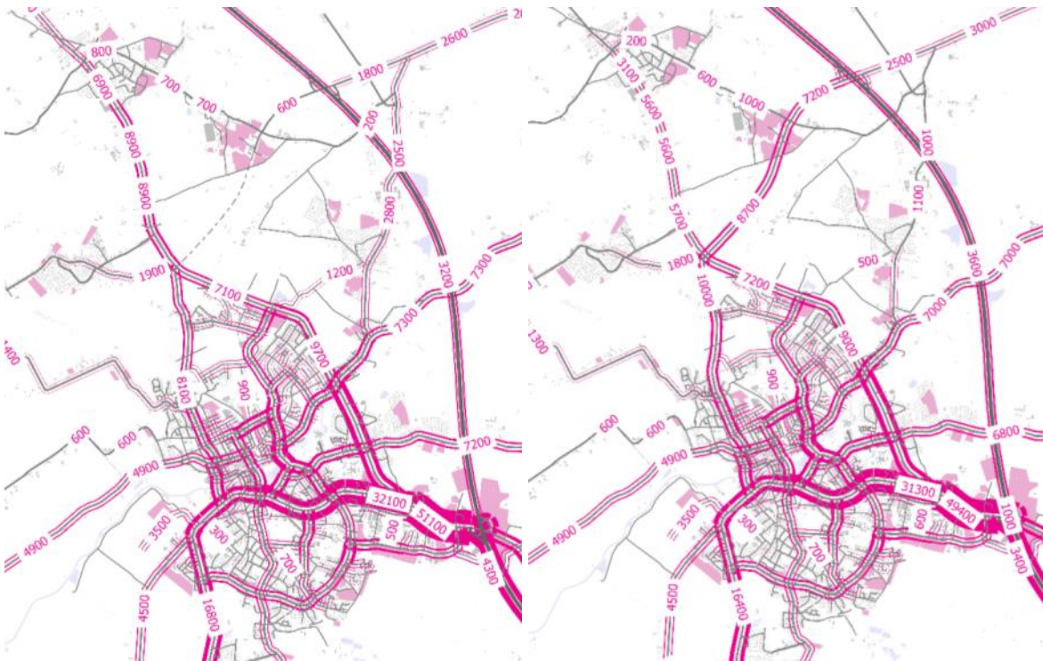
Abbildung 19: Strombündel der Quell-/Zielverkehre der Gemeinde Elmshorn im Prognose-Nullfall (links) und Prognose-Planfall (rechts) ( DTV_w , in Kfz/24h)
