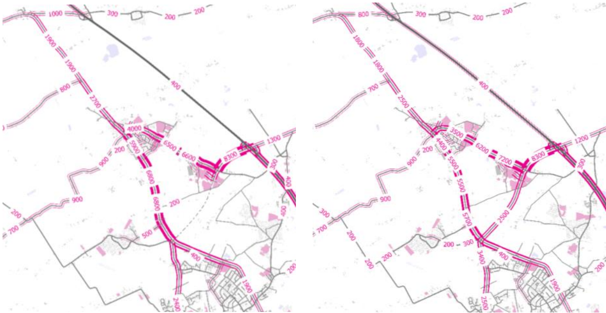
Abbildung 18: Strombündel der Quell-/Zielverkehre der Gemeinde Horst im Prognose-Nullfall (links) und Prognose-Planfall (rechts) ( DTV_w , in Kfz/24h)
